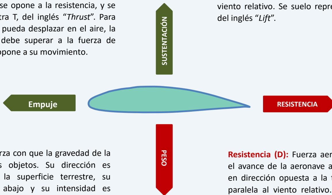
**Peso (W):** Es la fuerza con que la gravedad de la tierra atrae a los objetos. Su dirección es perpendicular a la superficie terrestre, su sentido es hacia abajo y su intensidad es proporcional a la masa de la aeronave. Se suele representar con una W del inglés “*weight*”. Deberá ser contrarrestada por la sustentación para que la aeronave pueda alzar el vuelo.
