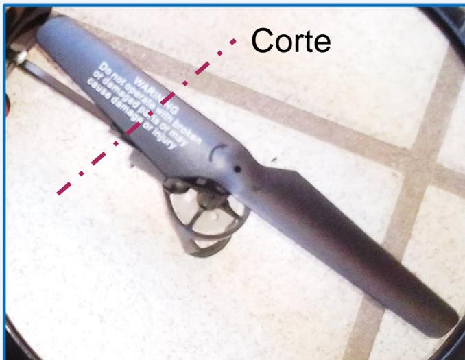
Si hacemos un corte a la hélice como se muestra en la fotografía obtenemos el perfil que se muestra a continuación.
